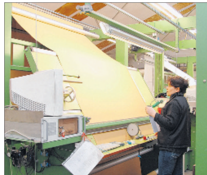
Am Ende der Produktion steht die Warenschau. Alle 100 Meter wird ein Meter herausgeschnitten und an ein unabhängiges Prüflabor geschickt.
