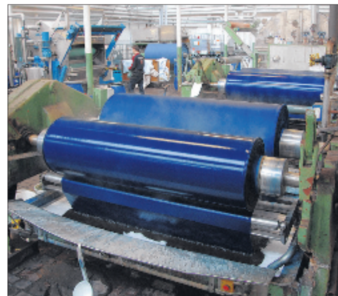
Bis zu zehn Mal durchlaufen die Gewebe in der Färberei die Flotte, also die in Wasser gelöste Farbe. Darüber hinaus werden auch Garne vor dem Weben gefärbt.
