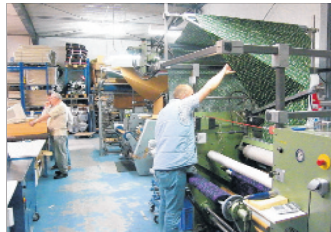
In den beiden Doubliermaschinen werden die auf Rollen angelieferten Stoffe auf halbe Breite gefaltet. In Kürze wird noch eine dritte Maschine hinzukommen.
