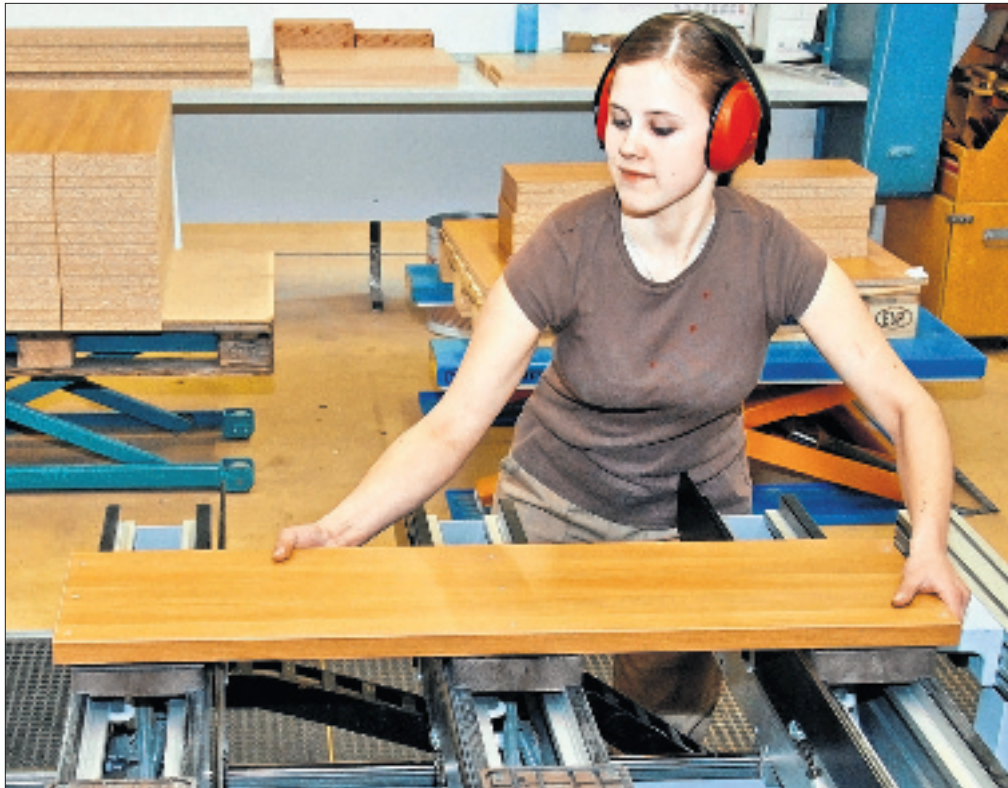
Einsatz im Bearbeitungszentrum an der CNC-Maschine: Maike Bartsch ist im zweiten Ausbildungsjahr bei der Tischlerei Wigger in Wilsum
