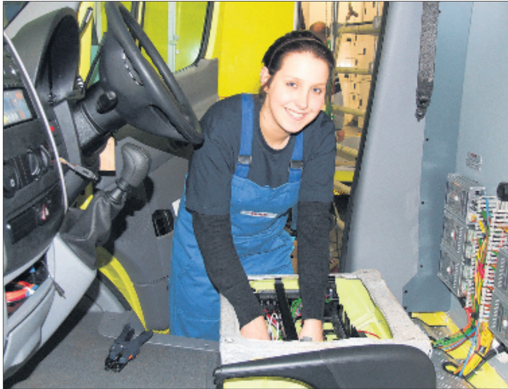
Die Elektronik in einen Krankenwagen zu verlegen, gehört zu den Aufgaben, die Jana Menger als angehende Mechatronikerin bei der WAS in Wietmarschen lernt. Foto: Niemann
